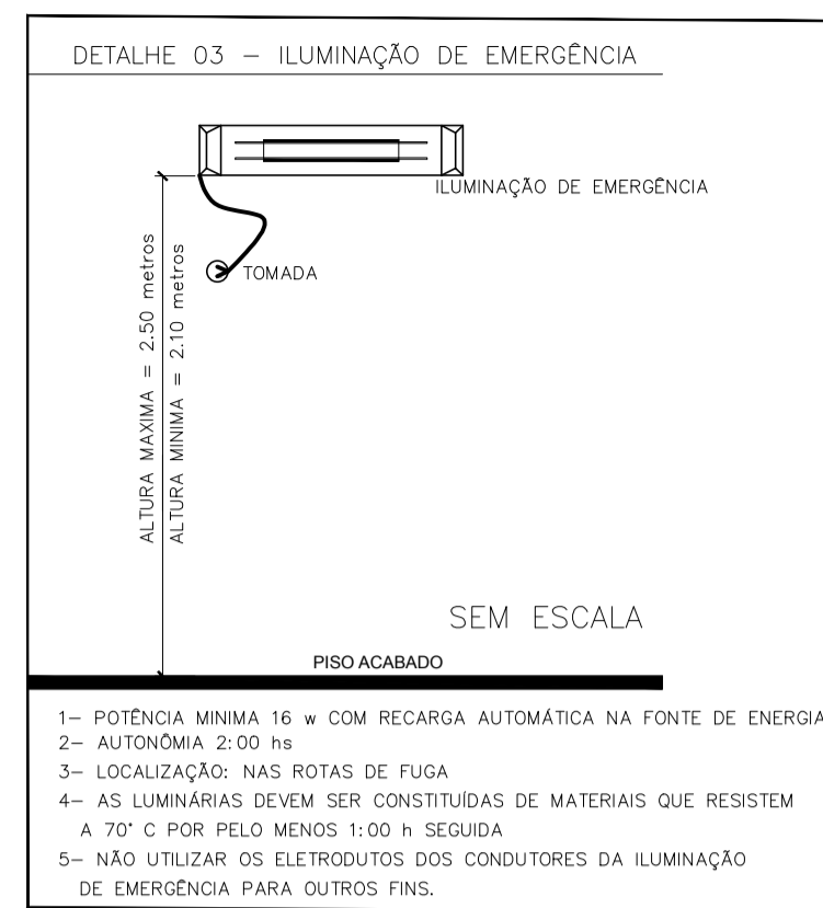
Detalhe Iluminação de Emergência Escala: Sem escala
